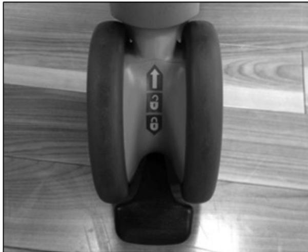
*Figura 3.4. Le ruote anteriori sono regolabili in tre posizioni: completamente bloccate, completamente sbloccate e bloccate in direzione rettilinea.*
