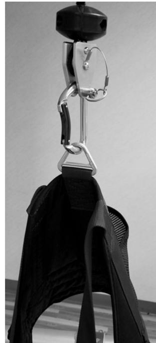
*Figura 3.3. Collegamento diretto ad un'imbracatura a punto singolo.*
