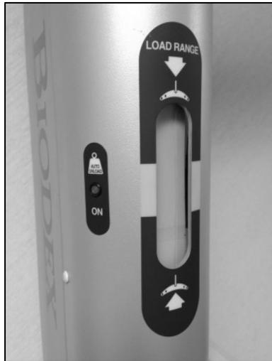
Abbildung 3.9. Die Entlastungskraftbereichsskala befindet sich auf der Hauptsäule.
