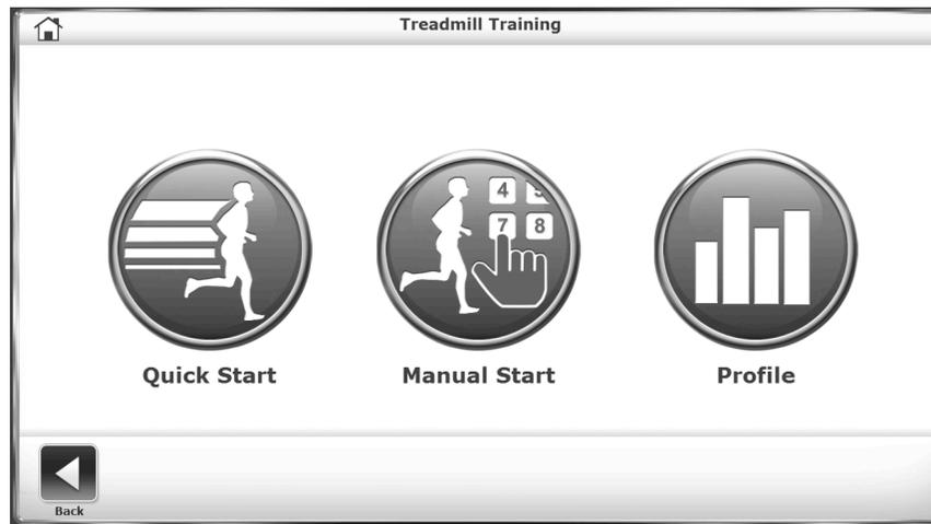
Figura 5.1. La funzione Avvio rapido permette all'utente di iniziare la seduta di esercizi con un numero minimo di dati da inserire.
