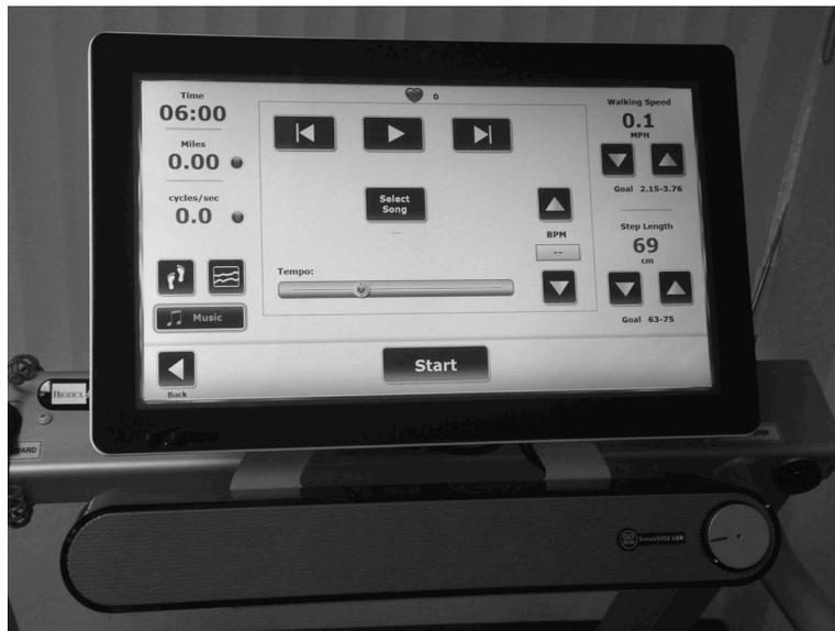
Figura 11.1. Display del Gait Trainer con soundbar per musicoterapia installata.
