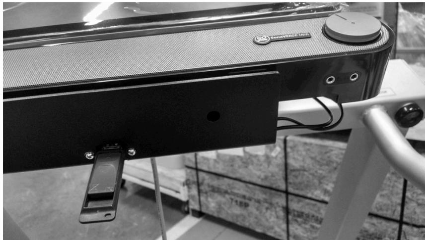
Figura 11.5. Si consiglia di utilizzare la porta USB situata al di sotto del display per l'inserimento dell'unità flash per i file di musicoterapia.
