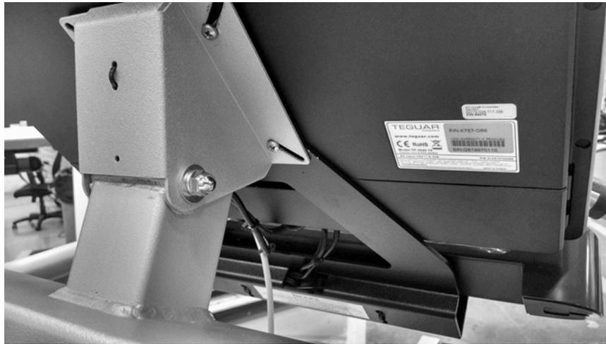
*Figura 11.2. La staffa di montaggio della soundbar viene inserita, facendola scivolare dietro la staffa del display del Gait Trainer, e fissata con le due viti di quest'ultima.*
