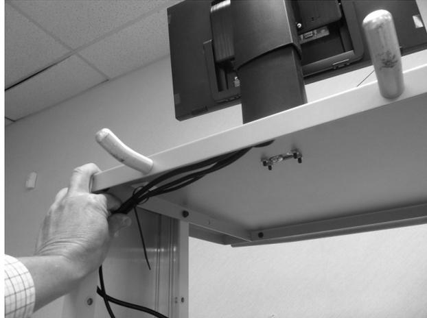
*Figure 28. Tying the Monitor Wires.*
